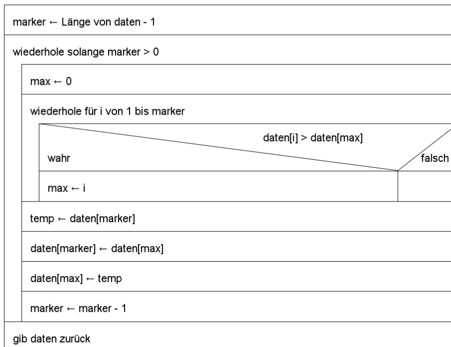
Abbildung 1: Struktogramm des Sortieralgorithmus SelectionSort
